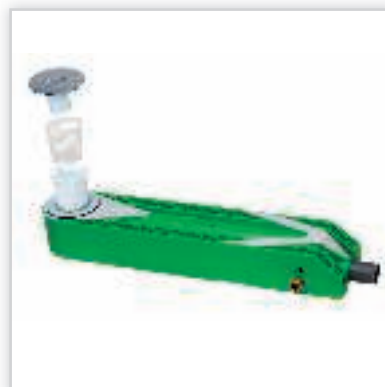
ECOMAX, ZypHO to rekuperator, który przekazuje ciepło z wody z prysznicy, na zimną, która przechodząc przez rekuperator dochodzi do baterii prysznicy wstępnie ogrzana, znacznie redukując ilość energii potrzebnej do podgrzania lub pobór ciepłej wody. ZYPHO ogrzewa wodę na zasadzie pracy biernej, urządzenie nie potrzebuje kompletnie żadnego zasilania ani jakiegokolwiek energii a zwrot inwestycji następuje po 2-3 latach.
